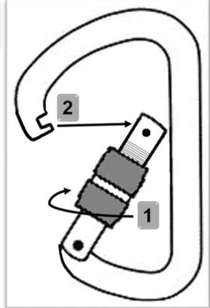
**Twist-Lock-Verschluss** – 1 Drehen dann 2 Öffnen
